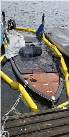
Oben und unten: Im Liegeplatz gesunkene Schiffe, schon fast wieder schwimmend.
