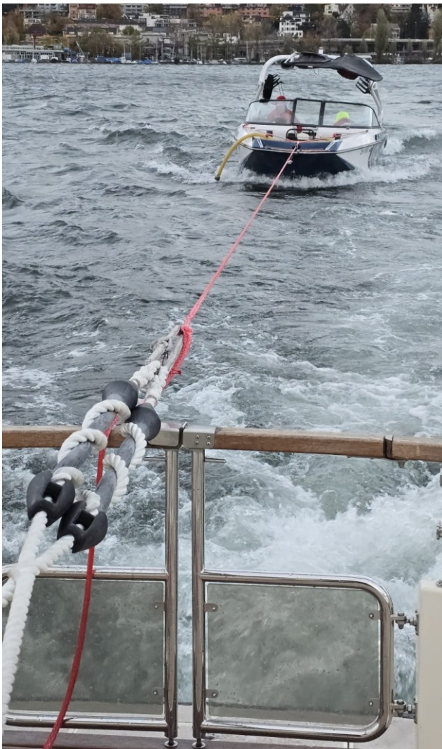
Schleppen mit beiden Pumpen im Einsatz, damit der leckgeschlagene Havarist nicht sinkt.
